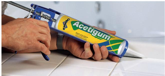
**Verarbeitung:** Schneiden Sie die Kartusche oben am Gewindeteil ab und schrauben Sie die Düse auf. Passen Sie den Auslass des Auslaufs entsprechend der Größe des Gelenks an. Schneiden Sie das Ende gerade genug ab. Mit einer Spezialpistole injizieren in die vorbereitete Kavität einfüllen und die Fugenoberfläche mit einem Werkzeug glätten. Üben Sie vor Beginn der Dreharbeiten ausreichend Druck aus oberflächlich.
