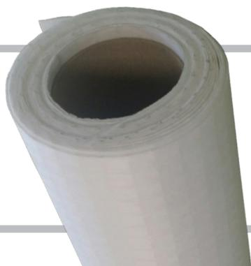
**Membrana desolidarizzante composta da due strati di tessuto in polipropilene con interposta una rete in fibra di vetro, distribuisce in modo uniforme le tensioni derivanti dal sottofondo. Indispensabile nella posa di rivestimenti a grande formato**
